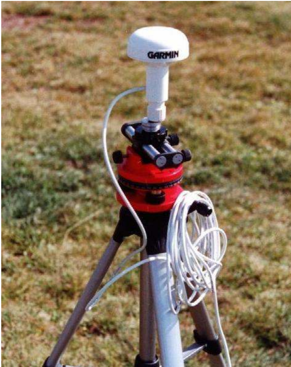
Antenna GARMIN GA21 utilizzata per la ricezione dei segnali GPS utilizzati georeferenziazione delle chiese dell'area di Valbrembo.
